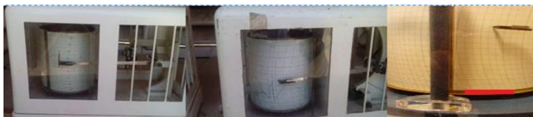
شکل ۱۴- تنظیم نبودن گراف، گیرکردن دستگاه‌های ثبات و عدم بررسی روزانه
