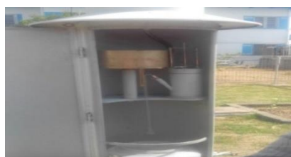
شکل ۱۶- عدم ریست کردن باران‌نگار هنگام تعویض گراف
