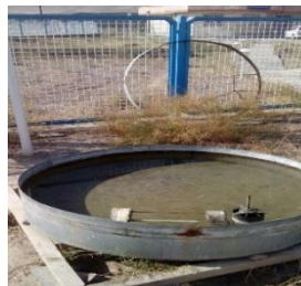
شکل ۱۱- نداشتن پوشش توری مناسب تشت تبخیر
