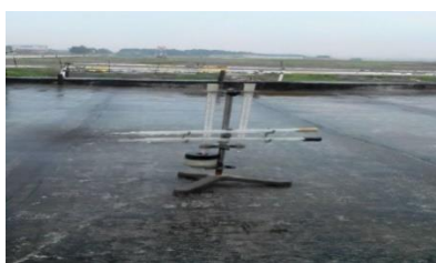
شکل ۷- قرار دادن مجموعه سایکرومتر و دماسنج‌های حداقل و حداکثر، در خارج از جعبه اسکرین
