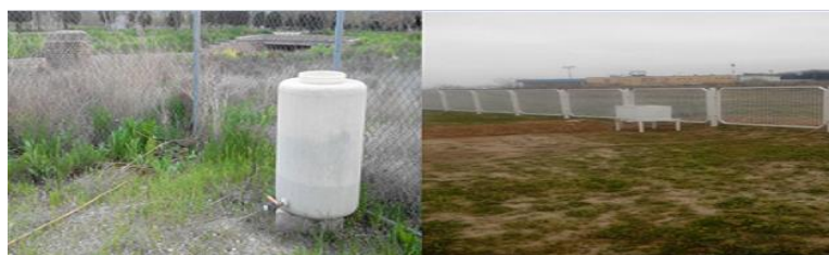
شکل ۱۰- استفاده از مخزن هم‌دمای غیر استاندارد
