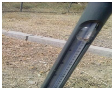
شکل ۱۷- استفاده از دماسنج خاک شکسته جهت داده‌برداری
