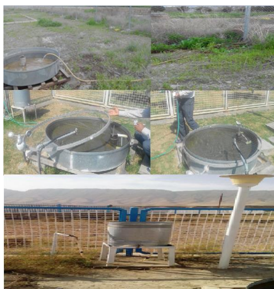
شکل ۹- استفاده مستقیم از آب شهری و عدم استفاده از تشت هم‌دمای جهت پر کردن تشت تبخیر
