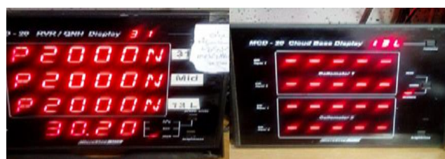
شکل ۲۱- خطا در دستگاه سیلومتر و دستگاه‌های دید در امتداد باند
