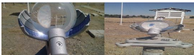
شکل ۱۵- عدم قرار دادن کارت در دستگاه آفتاب‌نگار یا استفاده از نوع کارت خارج از بازه زمانی استاندارد استفاده از آن کارت
