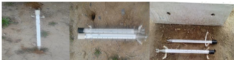
شکل ۱۲- روش‌های متفاوت قرائت دماسنج حداکثر زمین
