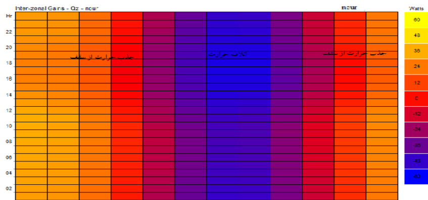
شکل ۱۴- اتلاف حرارتی از پوشش سقف ساختمان در محدوده پژوهش، ۹۸
