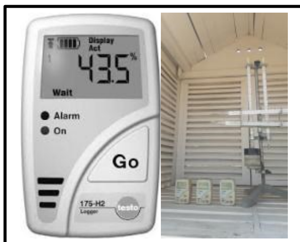
شکل ۴- دستگاه اندازه‌گیری درجه حرارت و رطوبت نسبی
