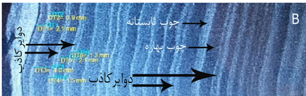
شکل ۳- نمونه ای از تصویر مقطع عرضی چوب زربین تهیه شده به روش عکاسی (A) و رادیوگرافی (B)
