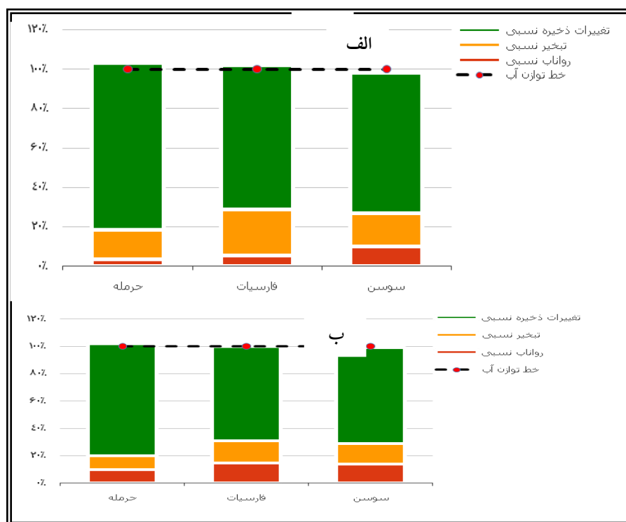
شکل ۷- نمودار بودجه آبی حوضه کارون در طرحواره‌های الف. NOAH و ب. NOAH-SIM در مدل WRF در زمستان ۲۰۰۶
